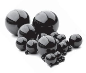
Kugeln aus Wälzlagerstahl haben eine Härte von 60 bis 66 HRC. Sie werden entsprechend den Angaben der ISO 3290-1998, in verschiedenen Genauigkeitsklassen geliefert. Innerhalb jeder Klasse ist das Abmaß in Sorten unterteilt, deren Toleranzen von der Klasse und dem Durchmesser abhängen.
